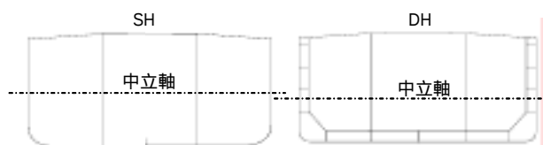
図 - 1 SH タンカー(左)と DH タンカー(右)の中央断面
