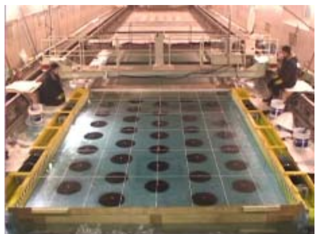
図10 3次元凹凸実験の初期状態
