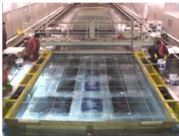
図 8 2 次元的凹凸氷板の実験の様子
