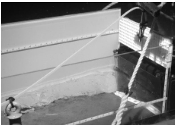
図 16 造波パドル付近の液体 \text{CO}_2 の様子。ハイドレート膜が伝播する様子が観察された。
