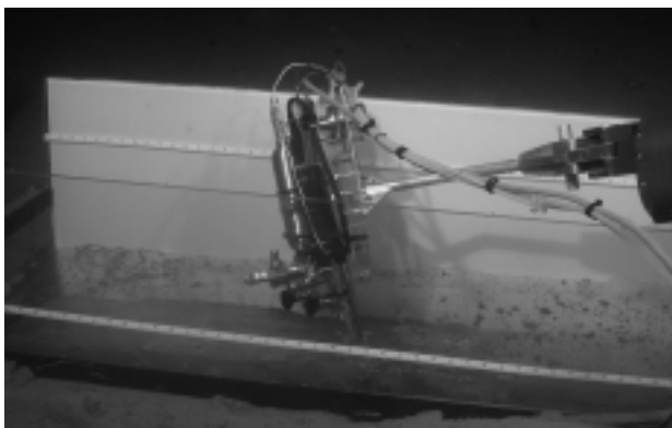
図 12 模擬貯留装置内の液体 \text{CO}_2 と pH センサ及びハイドレート膜に沈降した海底堆積物
