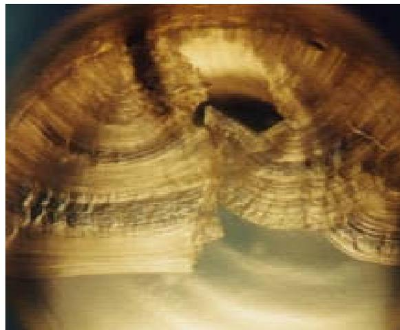
図 5 CO<sub>2</sub> ハイドレートの動的生成の様子<sup>(14)</sup> .
