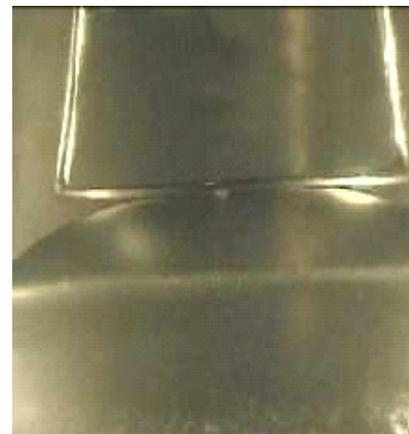
図4 ビーカーに溜められた液体CO<sub>2</sub>を薄いハイドレート膜が覆っている様子。膜で覆われた後では、膜の存在が分かりにくい(膜強度計測用の白金リングが写っている)。
