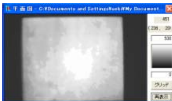
図8 ガンマ線均一照射(1.5Gy)した 2次元線量計からの熱蛍光量
