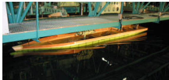
図 - 2 抵抗・自航試験状態(26 ノット相当)
