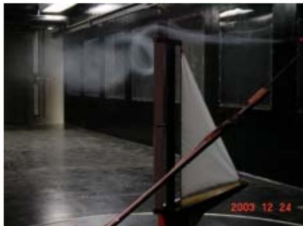
写真 - 2 最大揚力係数発生時の翼端渦
