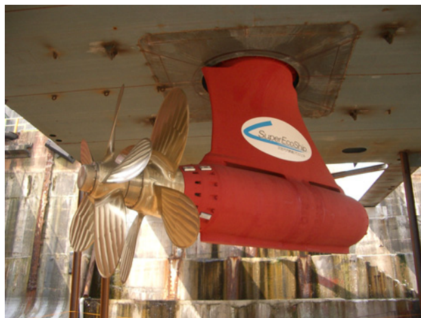
図6 二重反転プロペラ型ポッド推進器
