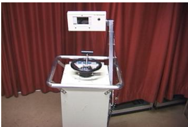
図5 直感的な方向、推力指示の可能なポッド制御用デバイス
