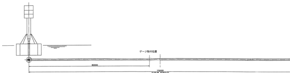
図 10 歪みゲージ設置位置
