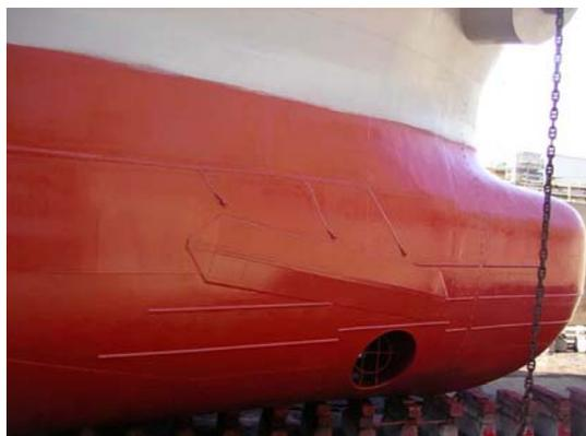
図 3 気泡吹き出し装置
