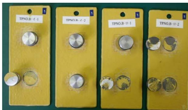
図5 開発塗料Bの破断面
