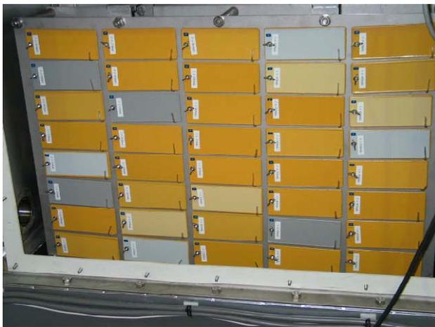
図 1 乾湿交番試験装置に配置した試験片
