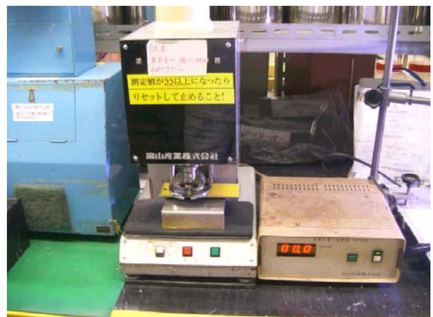
図 2 付着力試験装置
