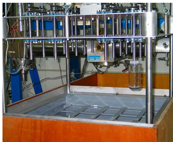
図 4. ASTM 準拠型新規銅溶出試験装置。上方は試験体保持・回転機構部、下部はエージング槽・溶出速度測定容器保持部を有する。
