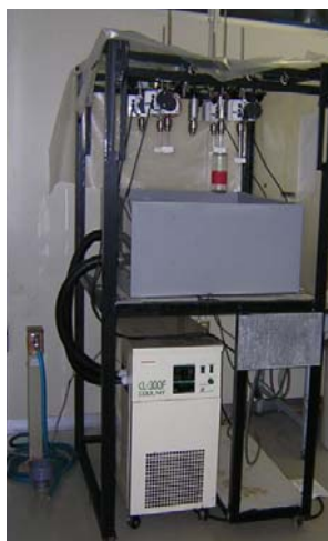
図 3. 従来型 ASTM 溶出試験装置。本試験では、試験体の溶出速度測定槽（左）とエージング槽（右）の 2 槽が必要となる。
