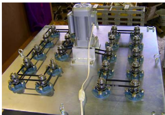
図 5. 新規装置の試験体回転機構. ベルトループによるホイスト方式により、多数の試験体を同時に評価できる機構を有する。
