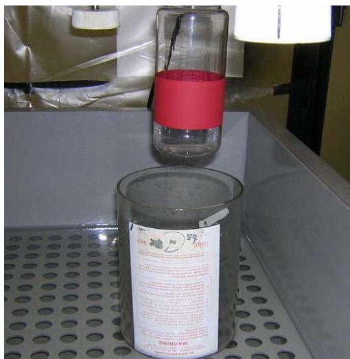
図 2. ASTM 用試験体（上方円筒型容器）および溶出測定容器（材質は共に P.C）
