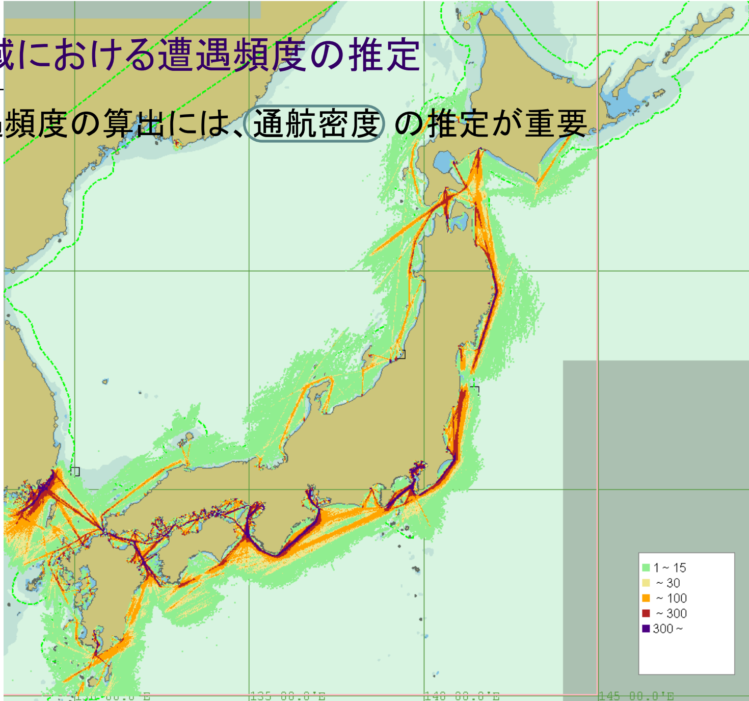
通航密度 (1/60度長さのゲート一日あたりの通航隻数) の計算例
