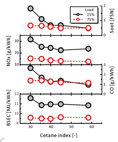
エネルギ消費率[MJ/kWh] =燃料消費率[g/kWh]x低位発熱量[MJ/g]
