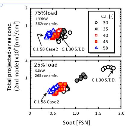
Soot;フィルタ捕集物質の反射率を計測
