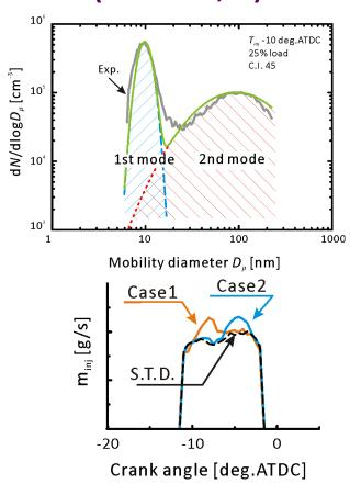
1st, 2ndモードの微粒子とも, 燃料噴射率よりも燃料の影響が大きい
