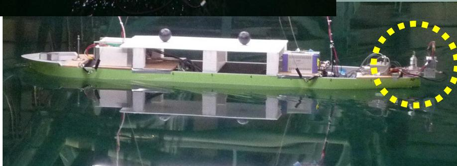
補助推力装置を搭載した
