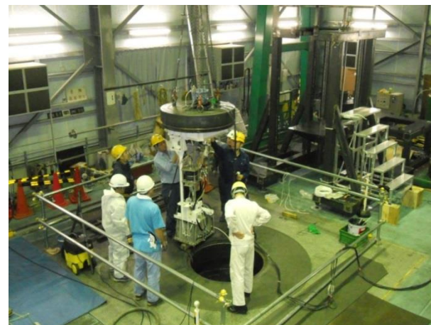
主要機器耐圧試験の様子
