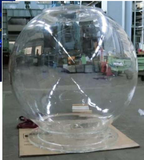
アクリル製球形タンク (直径1.2m)
