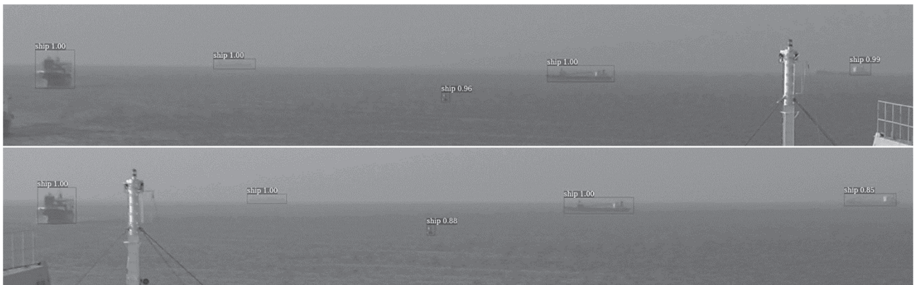
図-3 船影検出例（上：左舷カメラ，下：右舷カメラ．船首マストや荷役設備の一部が映り込んでいる）
