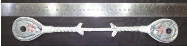
図-2 供試体の一例 (供試材料：ナイロン)
