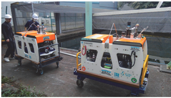
図-9 試験に使用した2機のアウバリング型 AUV ほばりん (左)・ほばりん2 (右)
