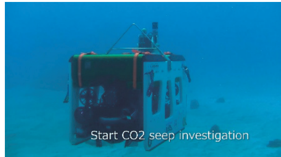
図-16 式根島御釜湾でのほばりん投入の様子と海底航走（高度1m）状況
