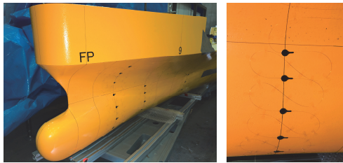
図-8 船体にFBG圧力センサを設置した外観
