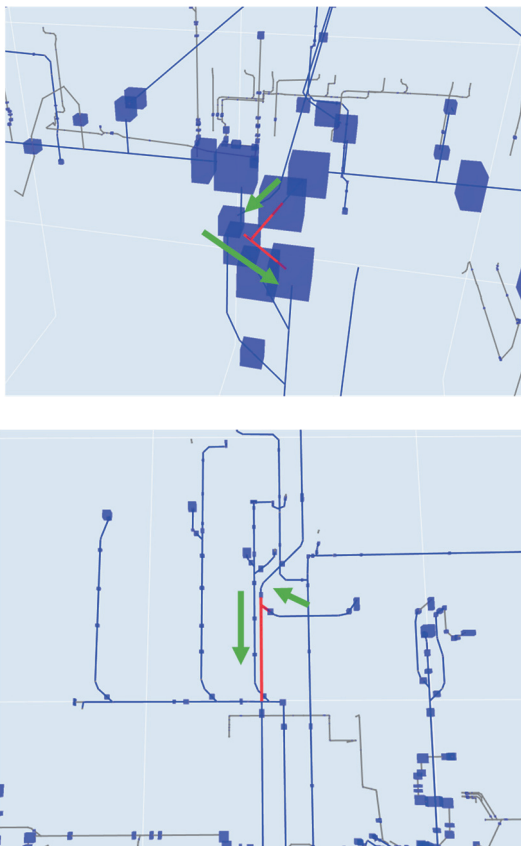
図-7 逆向き合流の検出結果例
