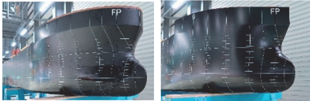
図9 原型 (Org. Hull) (左) と改良船型 (Imp. Hull) (右)
