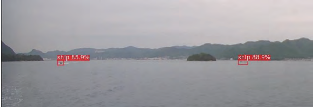
図-13 カメラ画像による他船検知の例
