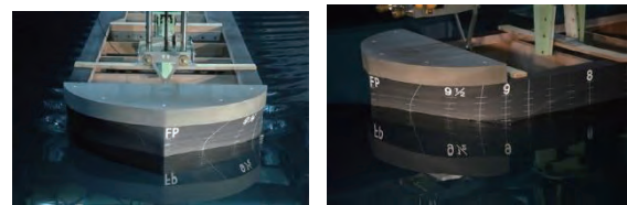
図-5 水槽試験における低速肥大船の造波の様子 (10kt) 4)
