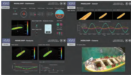
図-15 水槽試験での DT システムの GUI
