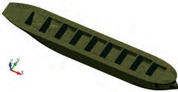
図-8 弾性模型船のFEモデル
