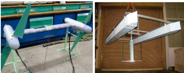
図-7 水平軸型の浮遊式潮流・海流発電模型<sup>24)</sup>（左図）および垂直軸型の浮体式潮流・海流発電模型（右図）
