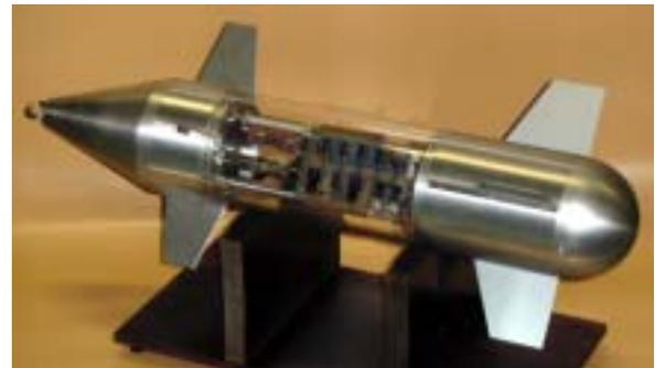
図-3 中継機の自由降下試験模型
