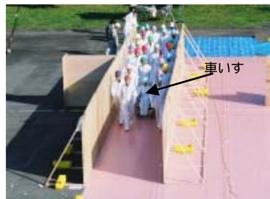
写真2 通路幅2mでの実験
