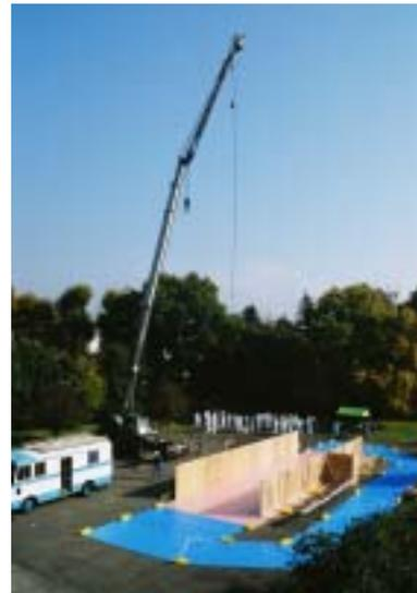
写真1 通路模擬装置と計測用クレーン
