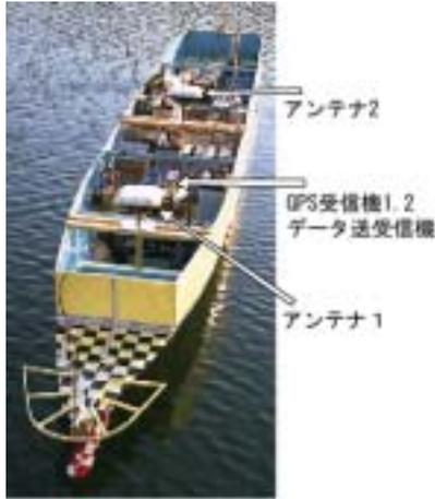
図 - 2 GPS装置の模型船上配置
