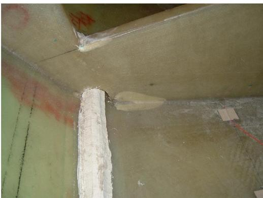
図-7 船底パネルと隔壁間の剥離箇所
