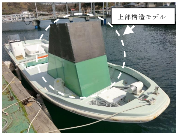
図-3 上部構造モデルを搭載した「あゆ」
