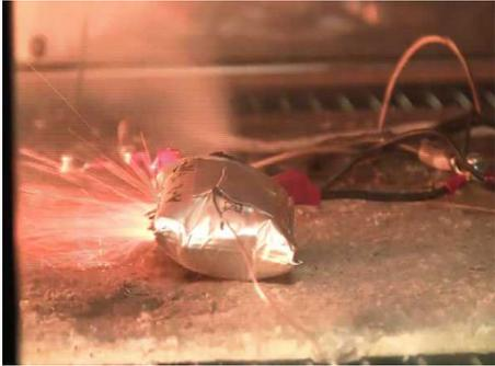
図-4 過充電試験によって発火しているセル A
