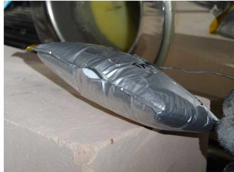
図-6 加熱試験後のセル B
