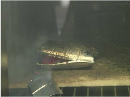
図-3 加熱試験後の針刺しで発火しているセル A
