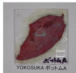
図-6 溶出試験片 (船底)
