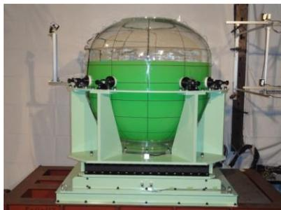
図-1 新形式タンク模型 (動揺装置に搭載した状態)
