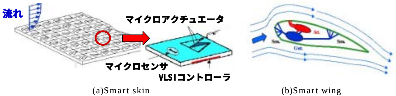
図3 壁乱流制御へのMEMS的アプローチにおける2つの手法
