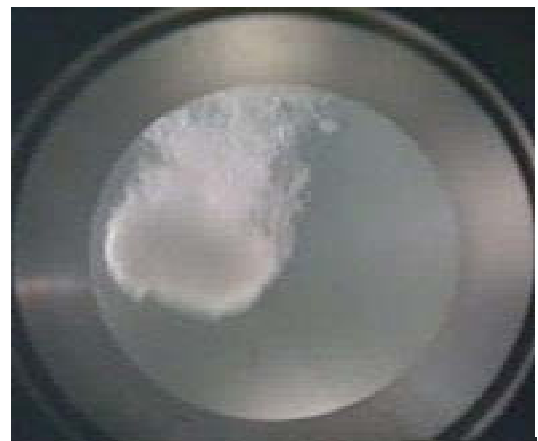
図 4 タンク内を自由沈降する氷層で覆われた CO 2 スラリー塊(大型タンク [大阪支所] の観察窓から見た様子)
