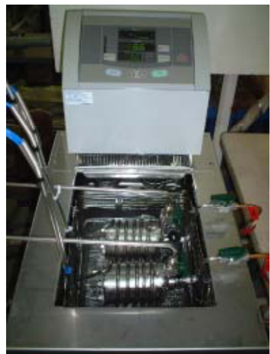
図 A-4 MHP 封入容器及び恒温槽
