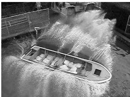
写真 3.4 落下試験 落下高さ 2.5m (満載状態)
