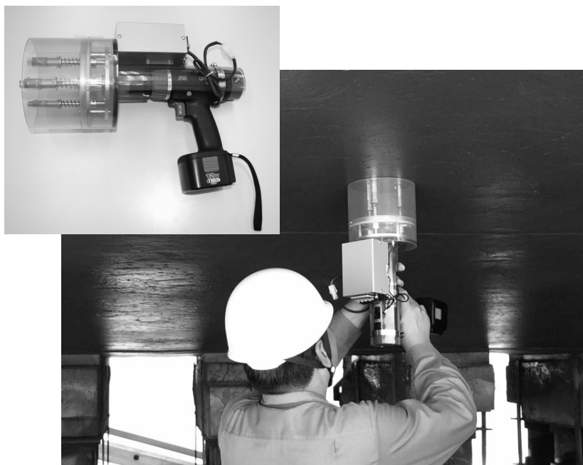
図 6-1 サンプルング装置(上)と船底からの試料採取状況
