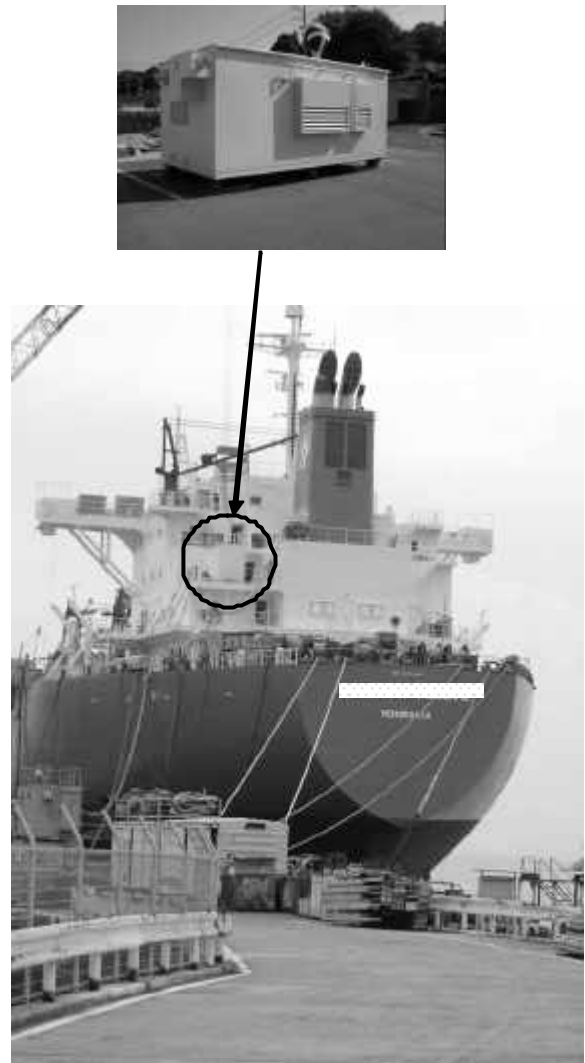
図 5-1 船舶に搭載された非常用発電機モジュール
