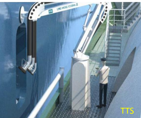
LNG transfer arm
