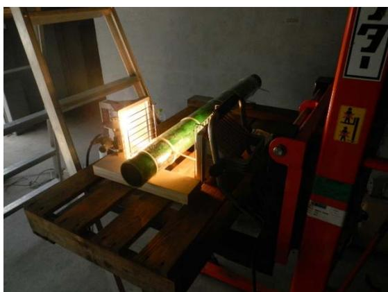
(a) 試作管の外側からハロゲンランプの光を照射
