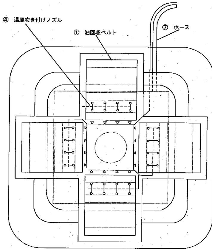
高粘性油回収装置（平面図）
