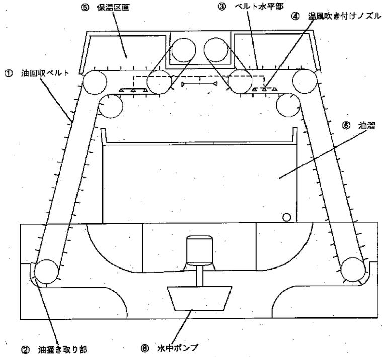
高粘性油回収装置（側面図）
