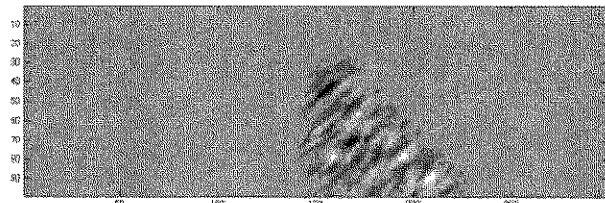
400-3 差分画像 亀裂高さ 8mm 画像-亀裂なし画像
