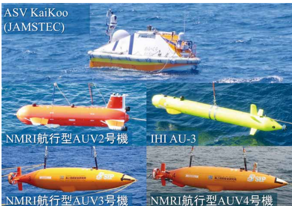
基本隊列制御により実現した異機種 AUV4 機と ASV1 機 (左) の同時運用による高精度・高効率な海底調査 (右)
