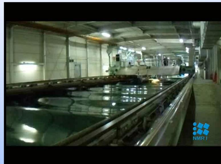
*f<sub>w</sub>*認証のための波浪中水槽試験の様子
