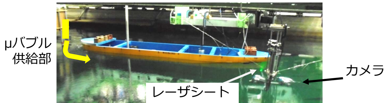
曳航水槽でのセットアップ（中水槽）
