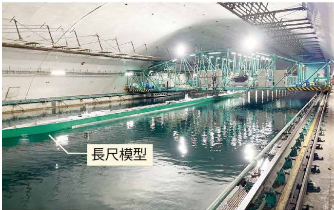
36m 長尺模型実験 (400m 水槽)
